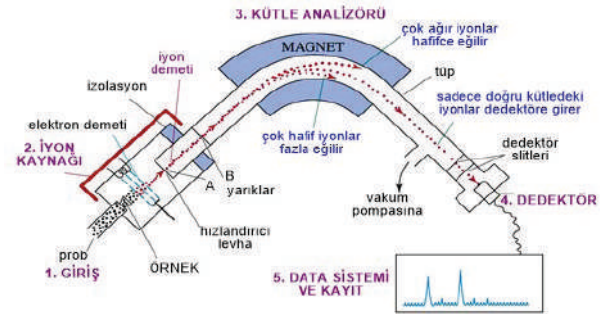
Şekil-4 Bir kütle spektrometrenin şematik diyagramı [14].
