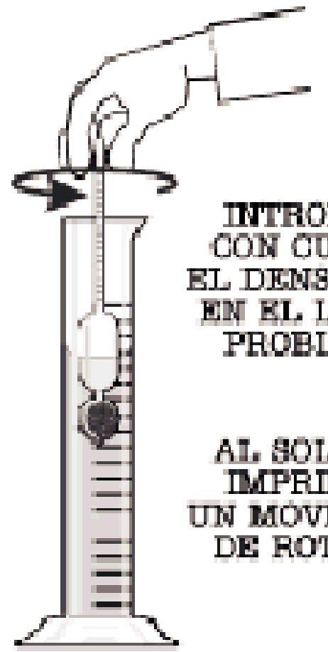
Principio de Arquímedes. Un cuerpo total o parcialmente sumergido en un fluido en reposo experimenta un empuje vertical hacia arriba igual al peso del fluido desalojado
