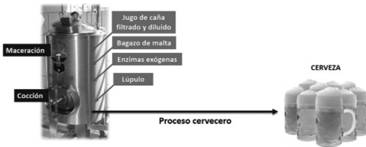
Figura 3. Producción de bebidas fermentadas de bajo porcentaje alcohólico (cerveza) a partir de la mezcla de jugo de caña y bagazo de malta.
