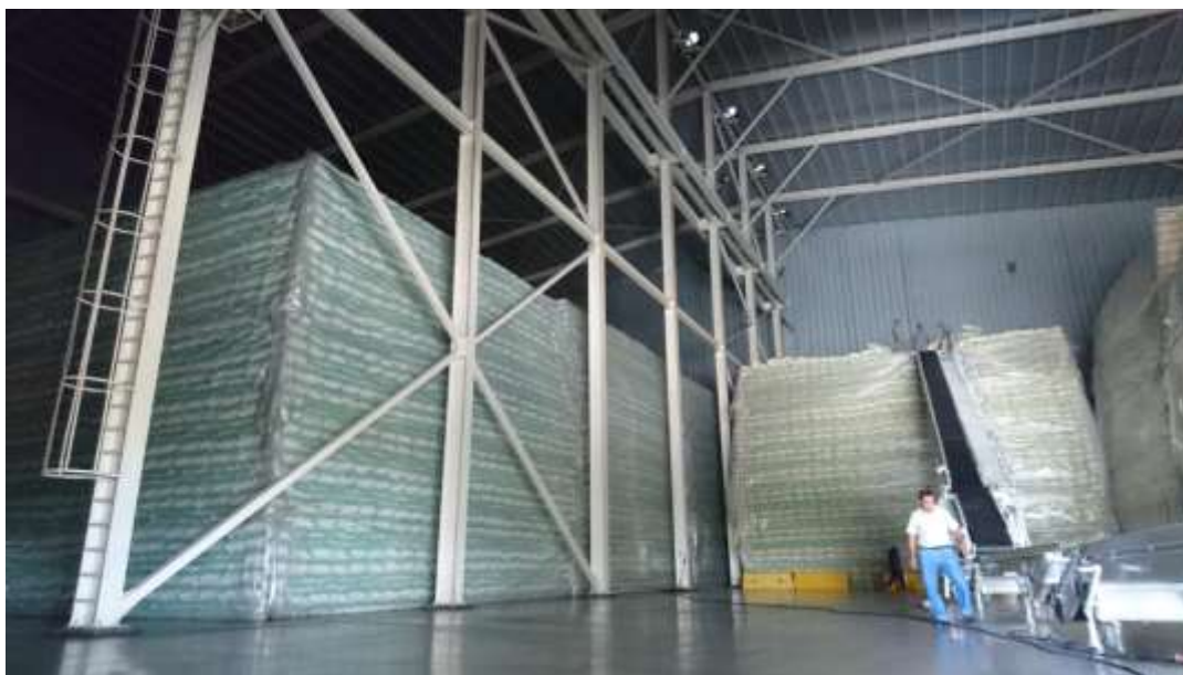
Figura 2.8 Almacenamiento en Bodega 5, estibas de 70 tendidos formadas al interior - banda utilizada para el despacho de azúcar.
