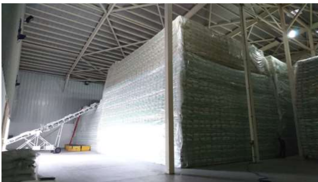
Figura 2.11 Almacenamiento en Bodega 6, estibas de 70 tendidos formadas al interior - banda utilizada para el despacho de azúcar.
