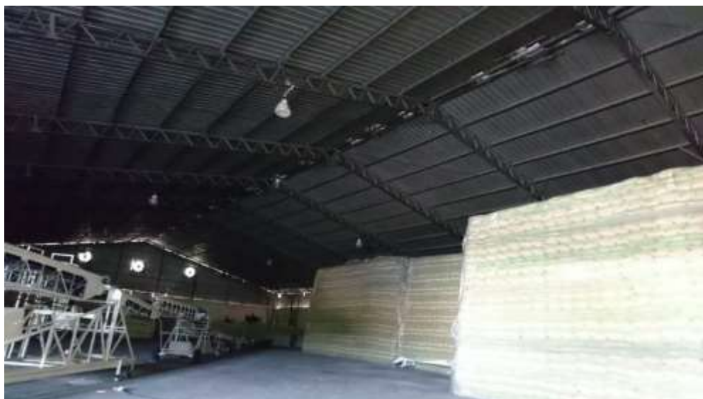
Figura 2.3 Almacenamiento en Bodega 3, estibas de 50 tendidos formadas al interior - banda utilizada para el despacho de azúcar.
