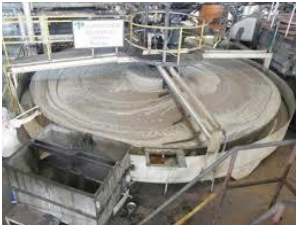
Gráfico N° 5.4.5 – Proceso de clarificación. Fuente: Web.
