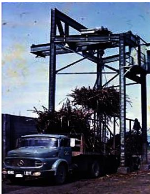
Gráfico N° 5.5.3 – Proceso de descarga con grúa hilo. Fuente: Web.
