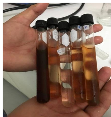
Ilustración 25, En el tubo de ensayo poner 2 ml de la muestra preparada, en otro tubo poner 2ml de disolución testigo y en otro 2ml de agua como blanco.
