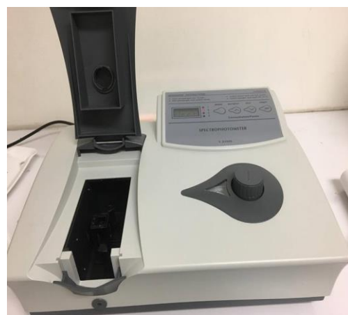
Ilustración 29, Leer el por ciento de transmitancia a una longitud de onda entre 538 y 543 nm contra el blanco usado como referencia.
