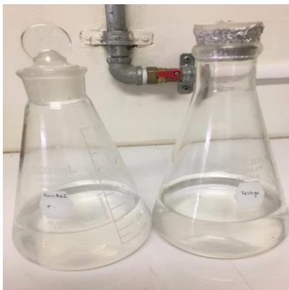
Ilustración 18, Decoloración total de la solución con la muestra y la solución testigo después de la titulación con el tiosulfato de sodio al 0.05N.
