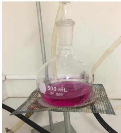
Ilustración 12, Muestra neutralizada y con la adición del exceso de hidróxido de sodio 0.1N
