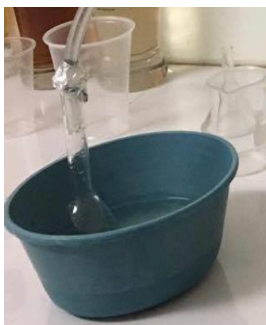
Ilustración 4, Matraz volumétrico sumergido en baño de hielo durante la destilación.
