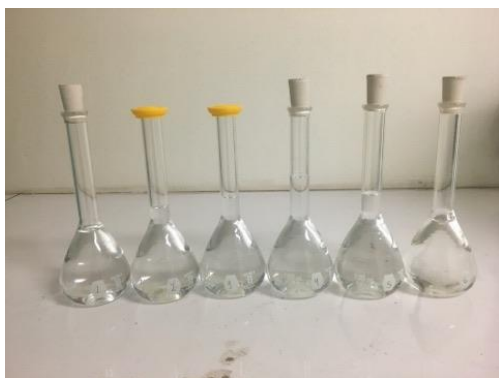
Ilustración 24, Preparar seis disoluciones en matraces volumétricos de 100 ml alícuotas de 1 a 6 ml de la disolución.
