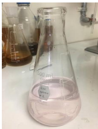
Ilustración 10, Muestra titulada para la determinación de acidez total.
