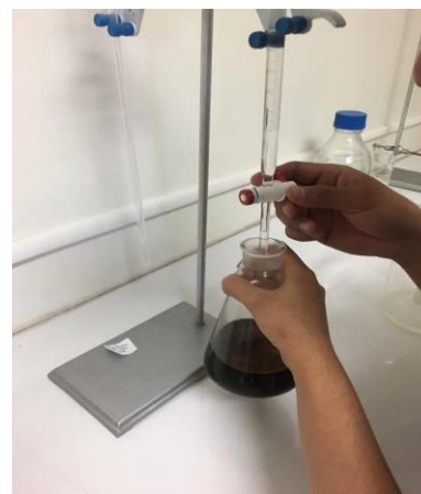
Ilustración 17, Titulación de la muestra con la solución de tiosulfato de sodio al 0.05 N.
