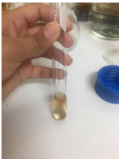
Ilustración 22, Adición del ácido cromotrópico después de la decoloración con el bisulfito de sodio.
