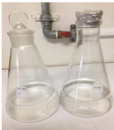
Ilustración 14, Solución a determinar y solución testigo transferida con la cantidad de agua destilada y el bisulfito de sodio al 0.05N.
