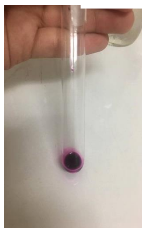
Ilustración 21, Adición de la gota de permanganato de potasio.
