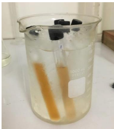
Ilustración 26, Los tubos se colocan en un baño de hielo.
