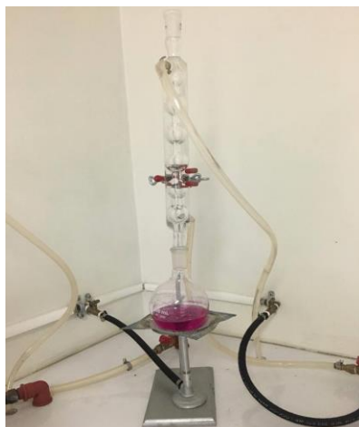
Ilustración 13, Sistema de reflujo que se utilizó para la determinación de esteres.
