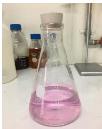
Ilustración 10, Muestra titulada para la determinación de acidez total.
