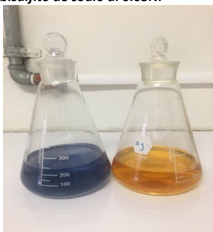
Ilustración 16, Coloración azul de la muestra al agregarle la solución de almidón al 1%.
