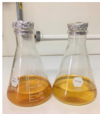
Ilustración 15, Adición del yodo al 0.05N después de transcurrir el tiempo de reposo.
