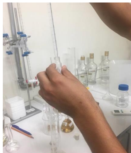
Ilustración 20, Adición de la gota de ácido fosfórico.
