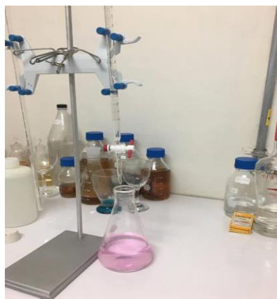
Ilustración 9, Titulación de la muestra con hidróxido de sodio al 0.1N utilizando fenolftaleína como indicador.
