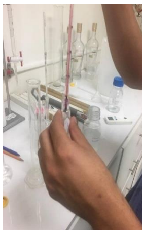
Ilustración 21, Adición de la gota de permanganato de potasio.
