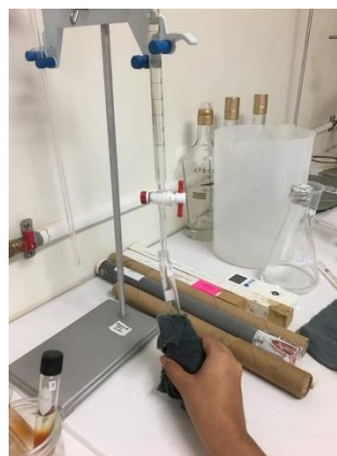
Ilustración 27, Adicionar a cada tubo lentamente gota a gota por medio de una bureta 10 cm 3 de ácido sulfúrico concentrado, dejándolo escurrir por las paredes, colocarlos en el baño de hielo durante 3 min
