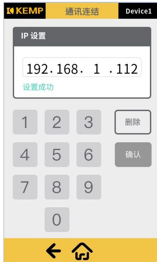
圖 4-33 ip 設置完成
