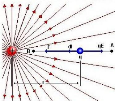
Considérense los puntos A y B y una carga puntual  $q_0$  situada en el origen, tal como muestra la figura. Consideremos que una carga de prueba,  $q$ , se mueve desde A hasta B. Si, por fijar ideas,  $q_0 > 0$ , según se muestra,  $\vec{E}$  apunta a la derecha y  $d\vec{l}$ , que siempre está en la dirección del movimiento, apunta hacia el origen. Por consiguiente:
