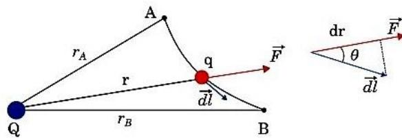
Un caso particular de la fórmula anterior, es el del caso de un campo eléctrico creado por una carga puntual estática  $Q$ . Sea una carga puntual  $q$  que recorre una determinada trayectoria **A - B** en las inmediaciones de una carga  $Q$  tal y como muestra la figura 1. Siendo  $d\vec{r}$  el desplazamiento infinitesimal de la carga  $q$  en la dirección radial, el trabajo diferencial  $dW$  se puede expresar así:
