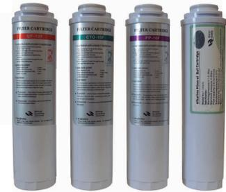
Este sistema de filtración cuenta con un cartucho de sedimentos, carbón granular, una membrana de UF que tiene una precisión de filtración de 0.01 micrones, elimina efectivamente el sedimento, oxido, bacterias, coloides, algas, materia orgánica macromolecular y otras sustancias dañinas, al final se tiene un cartucho alcalino que incrementa la alcalinidad y ph del agua. El proceso entero de producción de agua depende de la presión del agua de alimentación.
