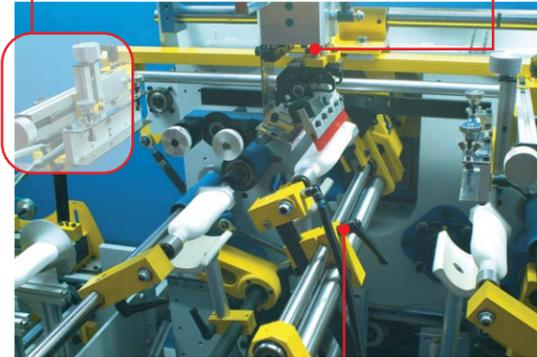
Dispositivo de inflado ajustable para impresión de envases ligeros o flexibles.
