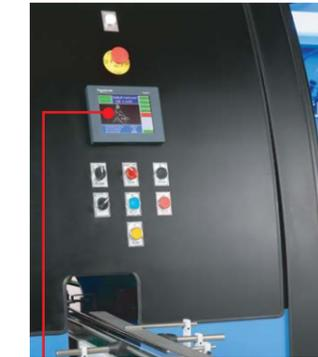
Con monitor de pantalla táctil para supervisar y ajustar todas las funciones de la máquina.
