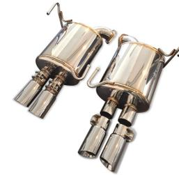
AVOカットバックエキゾーストシステムは排気口まで消音を設けた安全設計です。消音タイコ部分は楕円で最低地上高や消音容量を考慮し最適なルックスに上げています。マフラーハンガーは中空で吊りゴムが抜けにくい、プッシュストッパー機能付きです。出口は派手が無い代わりに、パワーを求めてエンジン立ち上りを追求しました。
