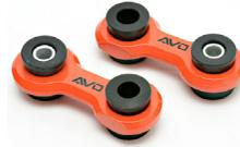
新機種車両のリア側には、AVO独自のポリウレタンブッシュとピロタイプを兼用したリアスタビライザーリンクによってスタビバーがしっかり車体の横揺れ防止機能を支えてくれます。調整幅も90-100mmで車高に応じた最適長さにできます。車両の下廻りにもAVOオレンジ色は、ワンポイントの華を添えるでしょう。
