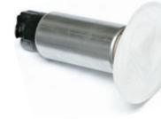
AVOフューエルポンプは、245-255L/hと純正比で約50%増量し、高回転での吐出量低下を防ぎます。パワーアップ車両やアフターパーツ交換に伴うノッキングを抑制します。プレッシャーレギュレーター装着前に絶大なる効果が得られます。AVOフューエルポンプには専用フィルタが付随されていて、吸引時のゴミを吸収すると同時に吸引抵抗も軽減しています。
