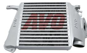
AVOトップマウントインタークーラーは、インプレッサ/レガシィをはじめ、フォレスター/エクシーガにもボルトオンで装着でき、タービンインレット側アウトレット側での圧損が無く、ブーストアップやパワーアップ車には最適です。内部構造は20年の実績あるAVOパープレートと、外部は熱放出し易いパウダーコーティングです。
