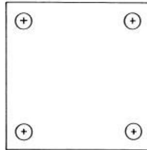
POSITION PLATES SO THAT FASTENERS ARE 6" MINIMUM
