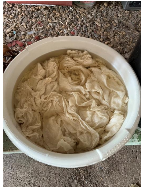
การปรับสภาพผ้าก่อนการย้อมด้วยน้ำพลาสมา โดยการแช่ในน้ำพลาสมา
