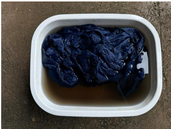
การปรับสภาพเส้นใยคืนความเป็นกลางด้วยน้ำมะกรูด และน้ำพลาสมา
