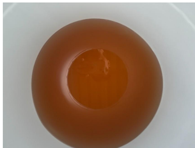
สีของน้ำหลังการแช่ด้วยน้ำพลาสมา โดยน้ำพลาสมาจะละลายสารเคลือบออกและปรับสภาพพื้นผิว
