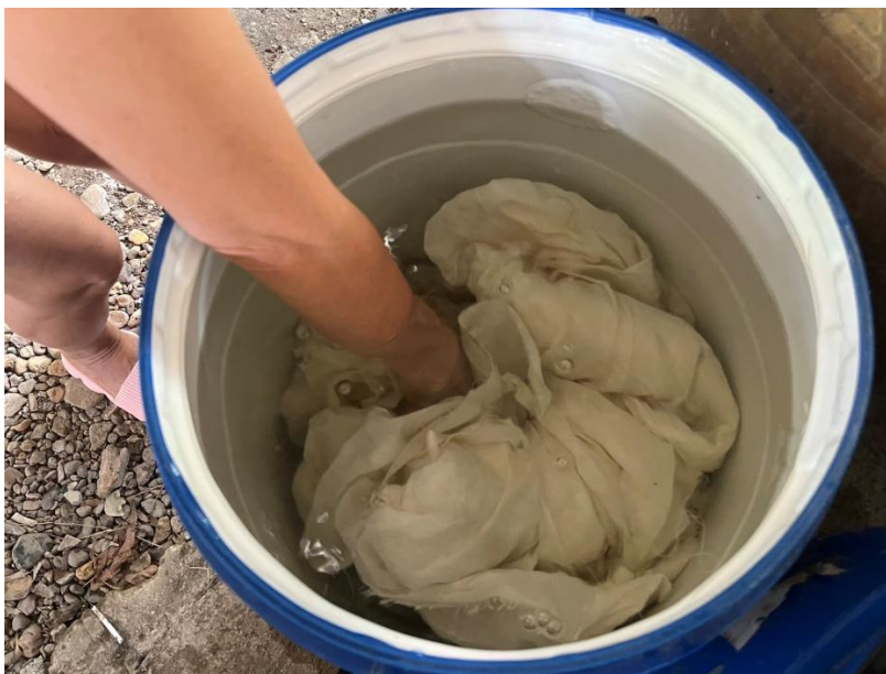
การปรับสภาพผ้าก่อนการย้อมด้วยน้ำพลาสมา โดยการแช่ในน้ำพลาสมา
