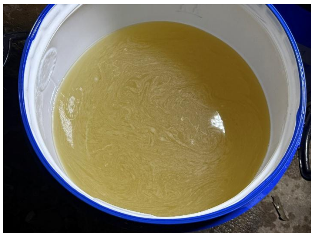
สีของน้ำหลังการแช่ด้วยน้ำพลาสมา โดยน้ำพลาสมาจะละลายสารเคลือบออกและปรับสภาพพื้นผิว
