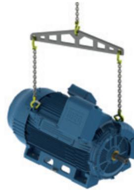
Figura 7 – Izamiento con corrientes verticales.
