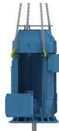
Figura 9 – Izamiento de motores verticales.
