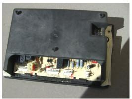
STEP 3. REMOVE THE REAR PLASTIC SHROUD IF YOU NEED TO GET TO WHERE THE DISPLAY CONNECTOR IS. AGAIN TAKE A PICTURE OF YOU PANEL AS YOU DISASSEMBLE IT.
