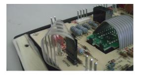
PLUG IN YOUR NEW KEYPAD TO THE KEYPAD CONNECTOR – JUST AS YOU UNPLUGGED THE OLD CONNECTOR
