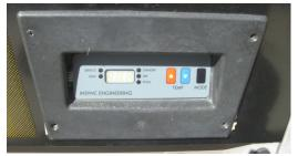
STEP 5. REMOVE THE OLD KEYPAD. IT SHOULD JUST PEEL OFF. THEN CLEAN THE OLD PLASTIC SURFACE WITH SOME WINDEX OR DEGREASER TO GET IT READY FOR THE NEW KEYPAD
