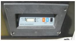
STEP 5. REMOVE THE OLD KEYPAD. IT SHOULD JUST PEEL OFF. THEN CLEAN THE OLD PLASTIC SURFACE WITH SOME WINDEX OR DEGREASER TO GET IT READY FOR THE NEW KEYPAD
