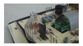
STEP 7. PLUG IN YOUR NEW KEYPAD TO THE KEYPAD CONNECTOR IN THE SAMEMANNOR THAT YOUR HAYWARD OEM PLUGGED IN. AVOID PINCHING THE CABLE. TUCK EXCESS CABLE AVOIDING TOUCHING ON COMPONENTS WITH CABLE.
