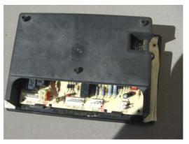
STEP 3. REMOVE THE REAR PLASTIC SHROUD IF YOU NEED TO GET TO WHERE THE DISPLAY CONNECTOR IS. AGAIN TAKE A PICTURE OF YOU PANEL AS YOU DISASSEMBLE IT.
