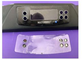
RUB OVER THE NEW OVERLAY AS THE ADHESIVE IS PRESSURE SENSITIVE, THIS WILL HELP MAKE SURE YOUR LABELS STAY ADHERED.
