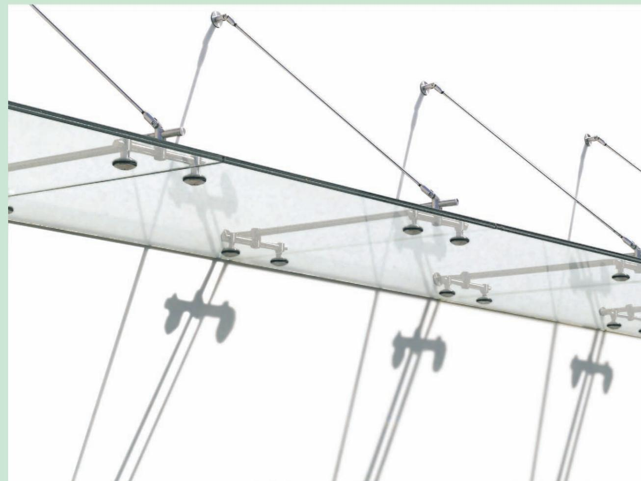
Das **DACHSYSTEM** ist ein bewegliches, nach allen Seiten gelenkiges und punktuelltes Befestigungssystem, welches speziell für Vordächer entwickelt wurde. Alle Metallbeschläge sind ausnahmslos in Edelstahl-Niro-Qualität. Sämtliche Beschlagsteile, die mit der Glasoberfläche in Berührung kommen, sind mit UV-beständigen Spezialkunststoffen ausgeführt.
