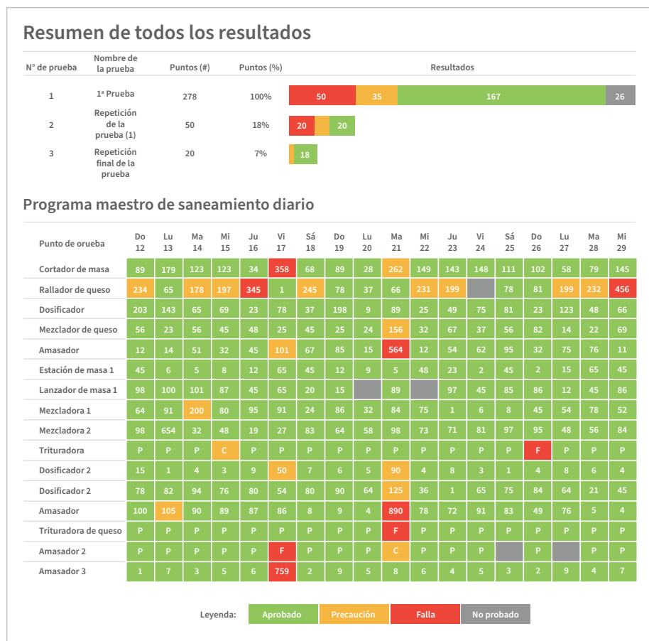
Figura 8. Software de tendencias de datos para evaluar la consistencia de la limpieza
