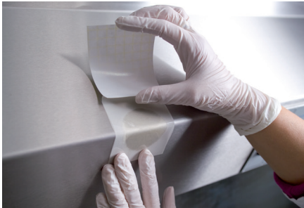
Figura 1. Ejemplos de contacto directo y muestreo con hisopo utilizando las Placas Neogen® Petrifilm®
