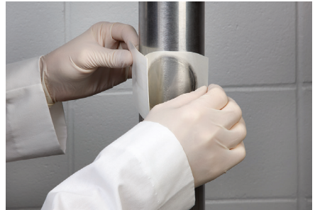
Figura 1. Ejemplos de contacto directo y muestreo con hisopo utilizando las Placas Neogen® Petrifilm®
