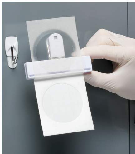
Figura 2: Ejemplo de muestreo de aire mediante las placas Neogen Petrifilm
