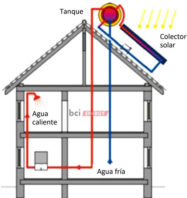
Por el hecho de trabajar con la presión atmosférica el tanque debe ser instalado lo más alto posible. El techo puede ser plano o inclinado.
