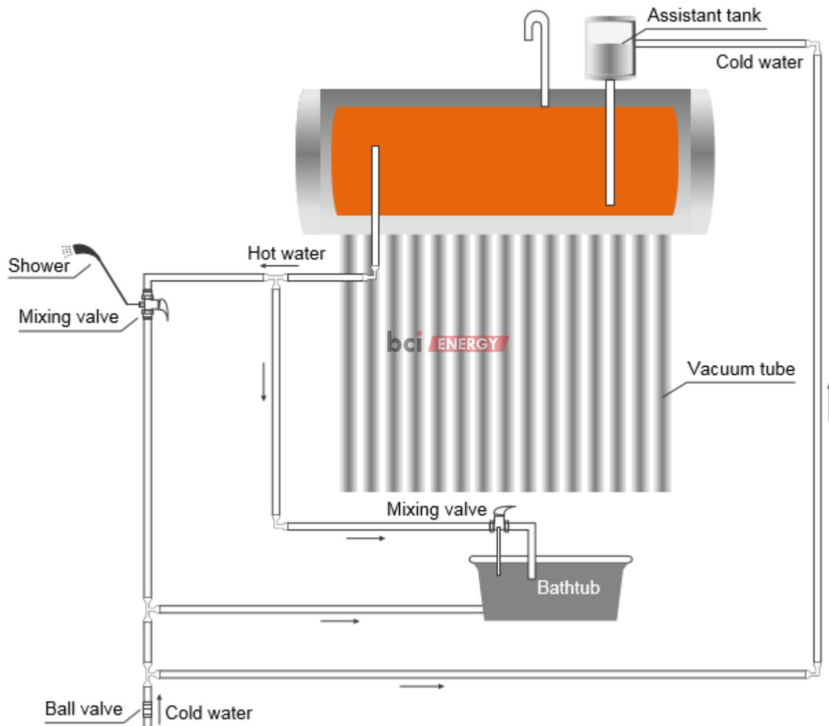
El funcionamiento está basado en el sistema de termosifón que trabaja con las diferentes densidades del agua fría y caliente: la primera tiene mayor peso específico y se mantiene abajo, mientras que la caliente fluye hacia arriba y esto genera la circulación hacia el tanque. Una vez lleno el tanque el sistema se estabiliza. Cuando mediante el uso el nivel comienza a bajar, el tanque asistente se encargará del llenado automático evitando así el problema del calentamiento de tanque seco.
