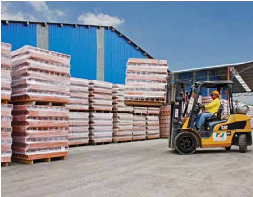
Ejemplo de un buen almacenamiento de ladrillo
