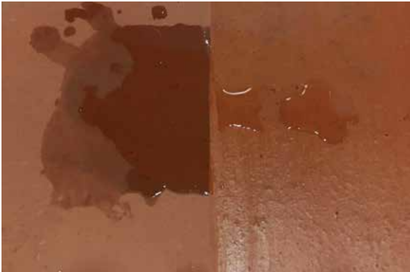
Lado derecho con hidrófugo y lado izquierdo sin hidrófugo
