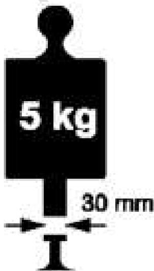
El instrumento utilizado para medir el espesor de la ropa y los zapatos debe ser capaz de medir una décima de milímetro (0.1mm). Las medidas se deben tomar con un pesa aplicada de 5 Kg. (carga). El instrumento debe tener dos superficies circulares de 30 mm. de diámetro una frente a la otra.
