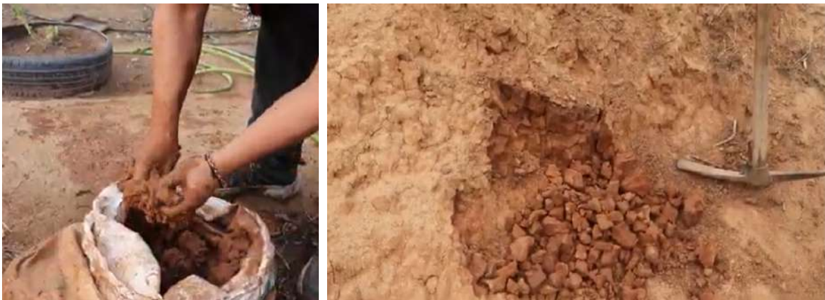
Fotografía 3 Detalle de la veta de arcilla para la confección del Tazón y guarda en saco plástico para mantención de humedad
