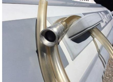
Un cycle de rinçage du tuyau se fera partir des réserves d'eaux propres de l'unité hôtelière flottante (20 litres d'eau circulant sous pression). Ce qui permet au moment du dévissage des embouts d'avoir un minimum de résidus d'eaux usées et de minimiser les odeurs.
