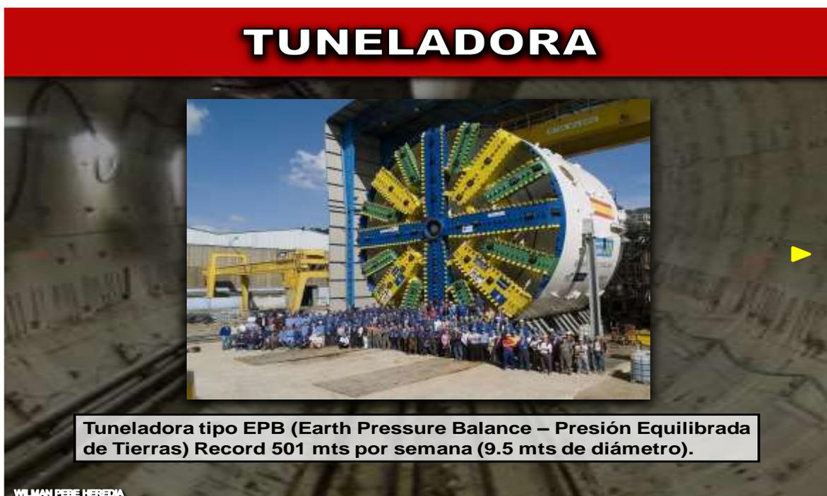
Figura N°60: Tuneladora tipo EPB (Earth Pressure Balance – Presión Equilibrada de Tierras) Record 501 mts por semana (9.5 mts de diámetro)
