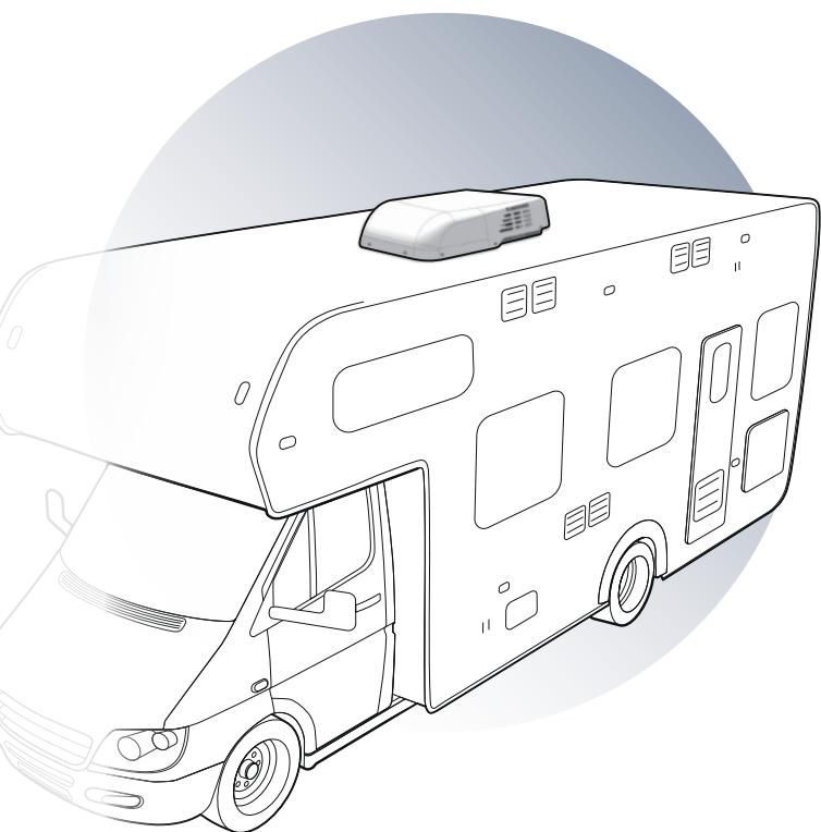
Condizionatore a tetto per campers, roulotte e cabine fisse per le quali sia possibile fornire un'alimentazione elettrica 230 V a.c. 50 Hz. L'RTEH, include il condensatore, l'evaporatore, il compressore ermetico ed i ventilatori ed è abbinato ad un diffusore aria da installare all'interno contro il cielo del veicolo.
