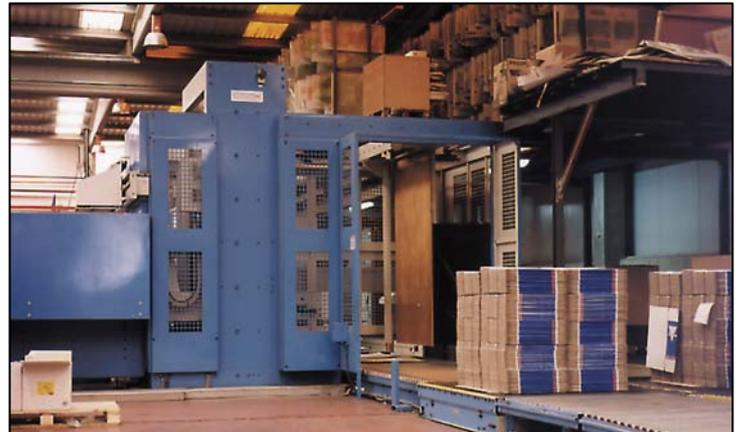
La paletización manual se sustituye a menudo por paletizadores. Estos equipos permiten constituir paletas de embalaje en plano en función de los formatos y de las necesidades del cliente.
