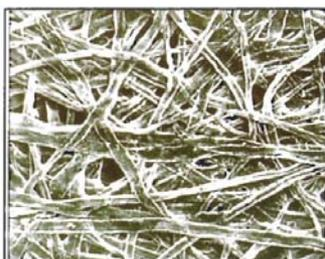
Superficie del papel vista por el microscopio electrónico
