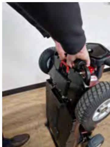
5. Um das hintere Teil zu entfernen, verwenden Sie den roten Hebel und ziehen Sie die hintere schwarze Stange nach oben, bis das Teil entfernt ist.
