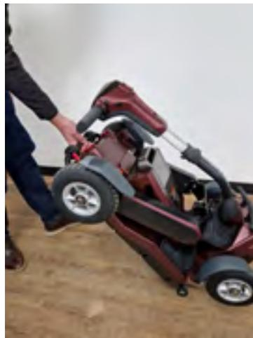
4. Benutzen Sie bei Bedarf den schwarzen Griff an der Rückseite des Rollers, um den zusammengeklappten Roller in seine aufrechte Position zu heben.
