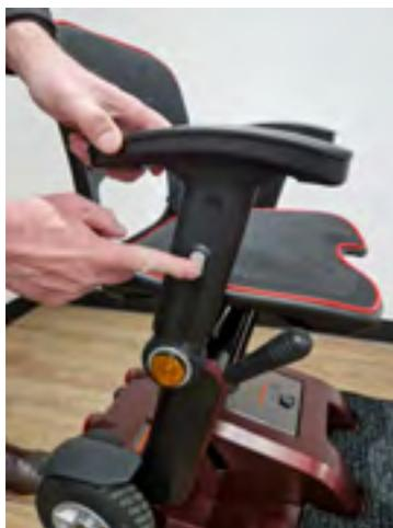
Um die Armlehne einzuklappen, drücken Sie den kleinen silbernen Knopf direkt über dem orangefarbenen Reflektor. Die Armlehne kann dann zusammengeklappt werden. Bitte beachten Sie, dass die Armlehne nur zwei arretierte Positionen hat - aufrecht und vollständig eingeklappt.
