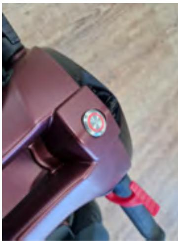
2. Drücken Sie die Klapp Taste an der Lenkstange des Rollers, um die elektronische Klappfunktion zu starten. Bitte beachten Sie, dass Sie diese Taste möglicherweise zweimal drücken müssen, um diese Funktion zu starten, wenn der Roller länger als 2 Minuten ausgeschaltet war.
