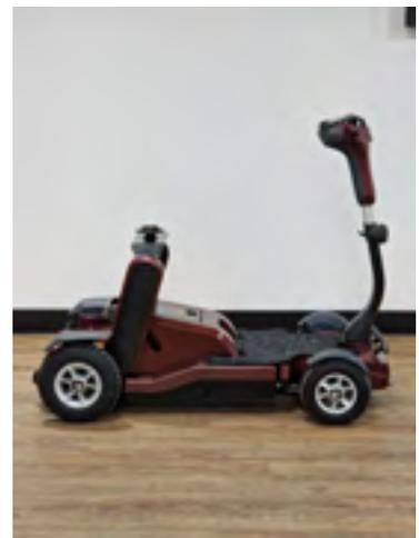
3. Der Roller beginnt dann mit seiner elektronischen Entfaltungsfunktion. Dieser Vorgang sollte etwa 15 Sekunden dauern.
