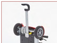
Ausziehbarer Lenker für einfachen manuellen Transport
