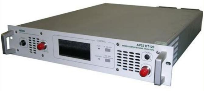
Les composants actifs conduisent durant moins d'une demi-période du signal d'entrée. C'est quoi un amplificateur de puissance classe D ? L'étage de sortie fonctionne en commutation, c'est-à-dire entre deux niveaux de tension. La fréquence de commutation est fixe mais le rapport cyclique de commutation est variable.
