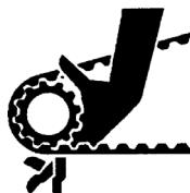
Nunca hacer reglajes o trabajos de mantenimiento con el equipo en movimiento.
