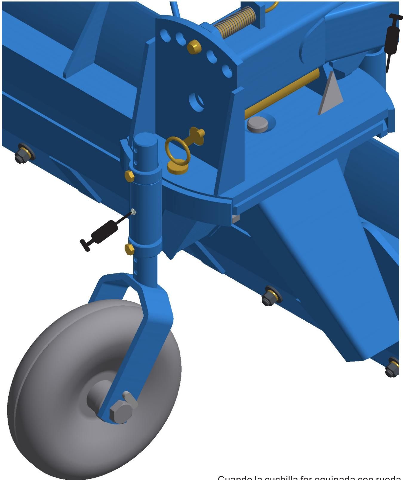
Cuando la cuchilla for equipada con rueda de control de profundidad, se debe lubricar las graseras a cada 50 horas de trabajo.
