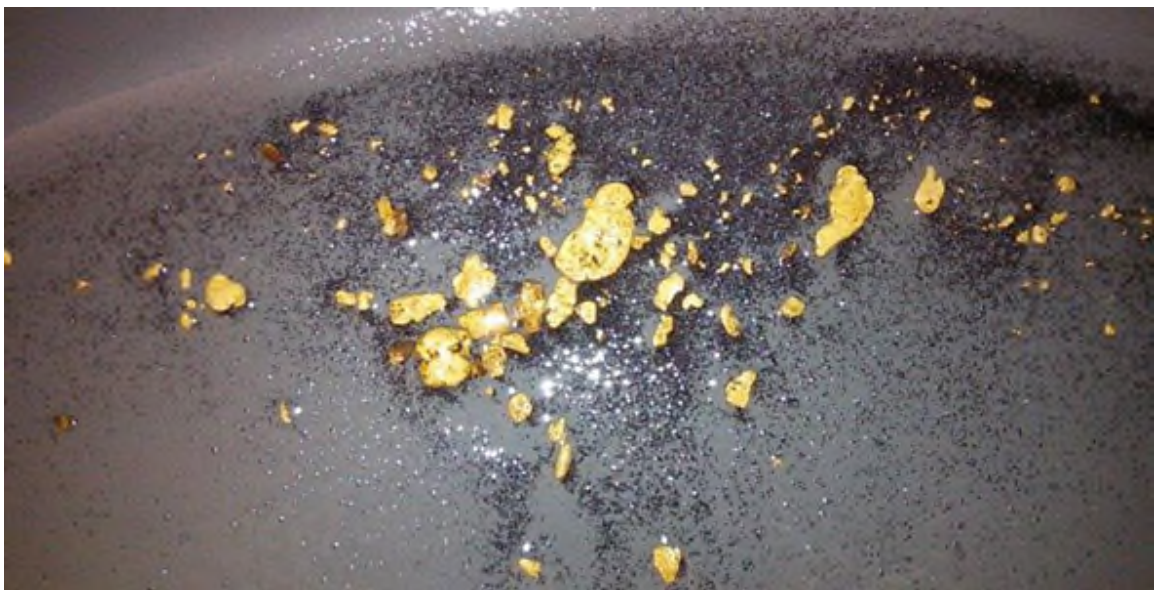
ORO PRIMARIO PRECIPITADO EN LOS TAPETES DE LAVADO PRIMARY GOLD PRECIPITATED IN THE WASHING TAPETES
