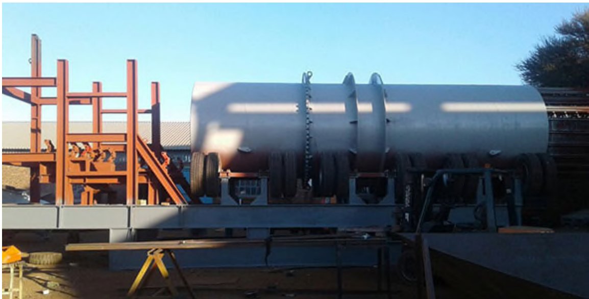
TUNEL DE PRELAVADO // PRE WASH TUNNEL
