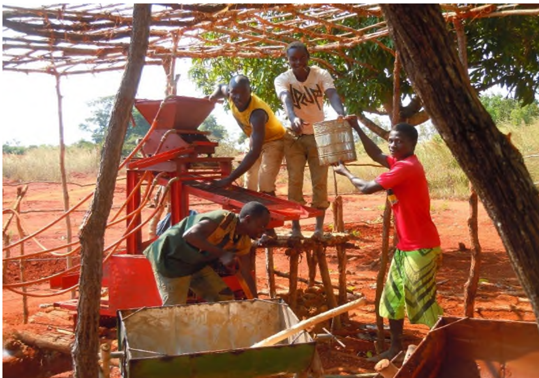
PROCESANDO ARENA (AU) CON COMPACTADORA KACHA III Y FILTRADORA BP-1 PROCESSING SAND (AU) WITH COMPACTOR KACHA III AND FILTER BP-1
