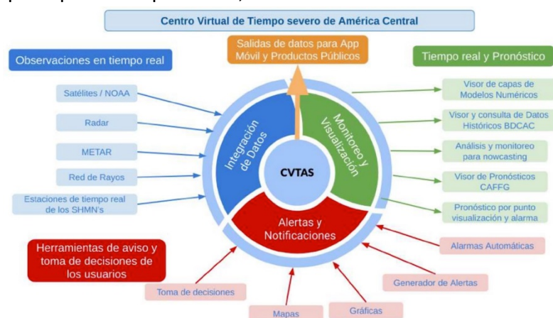
Figura 1. Esquema operativo de la plataforma CENTROCLIMA.
