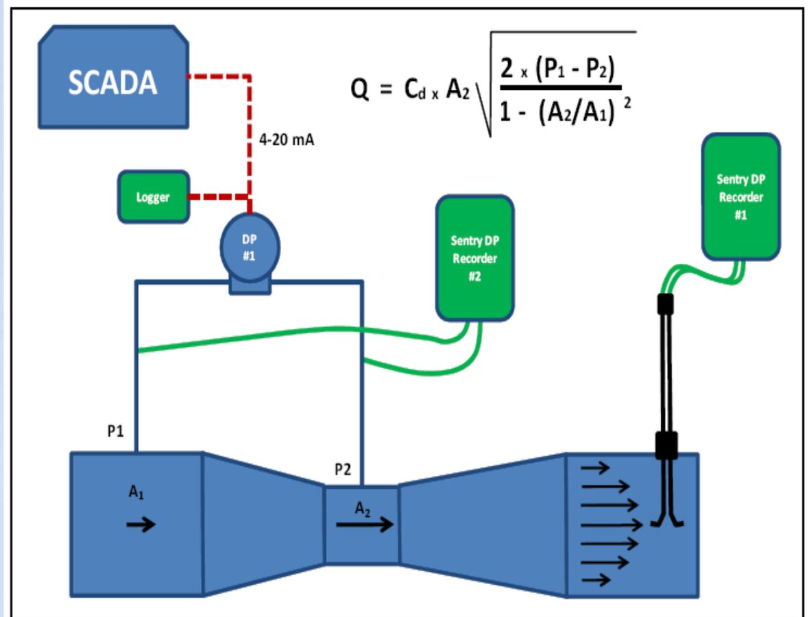
Fig. 1 – Venturi Meter Test Set Up
