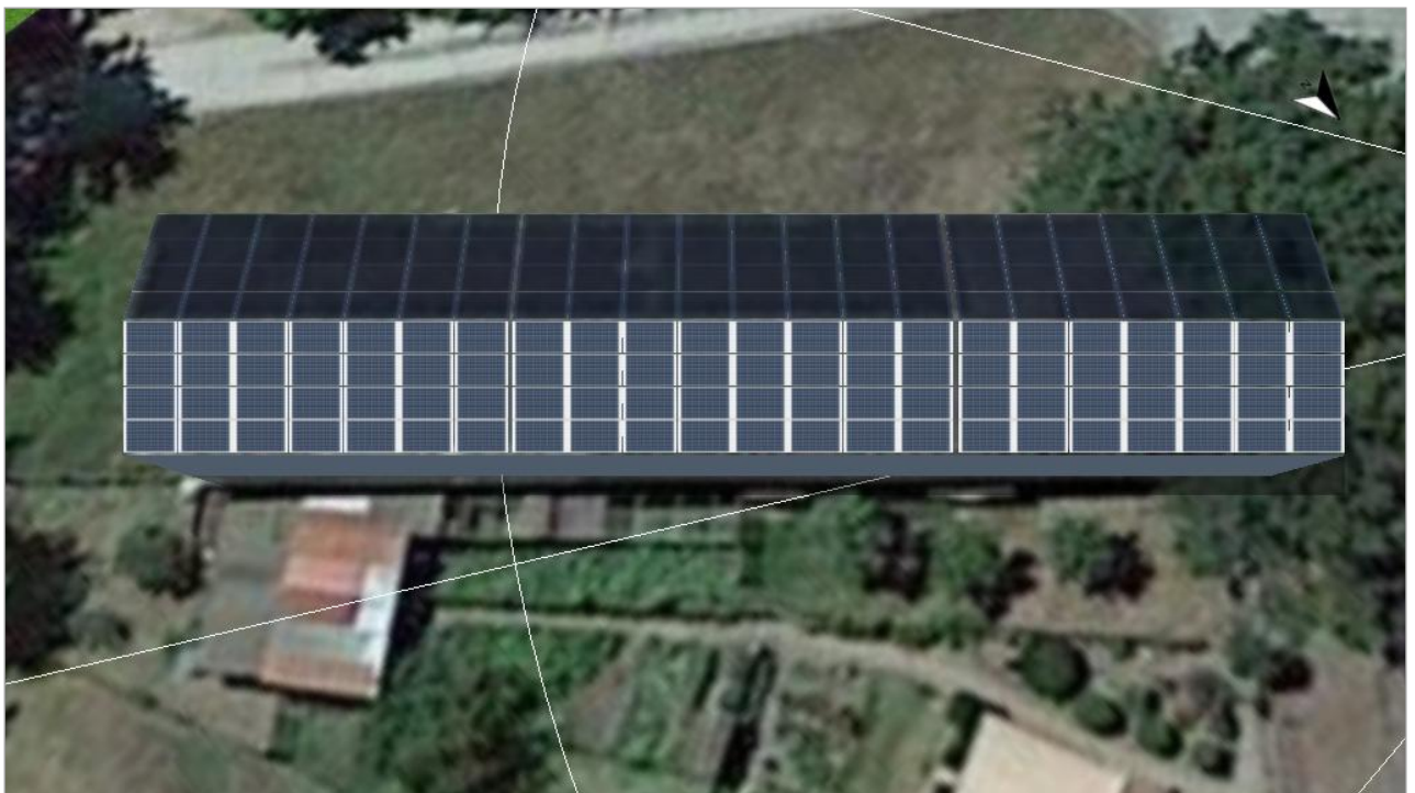
Abbildung: 1. Modulfläche - Gebäude 02-Dachfläche Nordost
