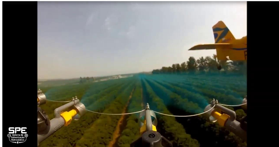
Figura 19 - Visão do sistema SPE, com destaque para os eletrodos e a neblina com pigmento fluorescente. Fonte: www.travicar.com.br
