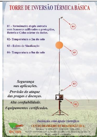
Torre de Inversão Térmica
