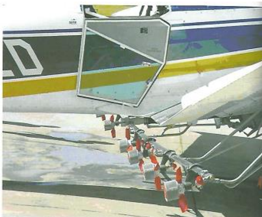
Figura 11 - Vemos a instalação em uma aeronave - Instalação de Micronair AU-5000 em aeronave. Fonte: Antuniassi & Boller, 2001.
