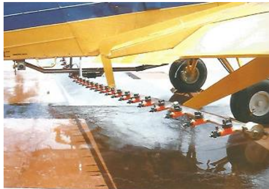
Figura 8 - Esquema de montagem dos Bicos CP na Barra. Foto: Antuniassi & Boller, 2011.
