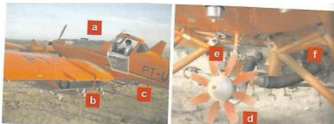
Figura 2 - Sistema de pulverização da aeronave agrícola Ipanema: (a) hopper (reservatório para insumos); (b) barra de aplicação; (c) válvula de abastecimento rápido; (d) bomba de acionamento eólico; (e) comporta para alijamento da calda; (f) válvula de 03 vias.
