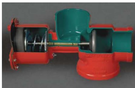
Nuestra válvula de retrolavado de acero fundido patentada está diseñada para ser 100% reparable en el campo con herramientas básicas. Las válvulas tienen ejes de acero inoxidable anticorrosivo, buje de bronce, sellos durables de poliuretano moldeado, revestimiento epóxico fundido a la válvula y una grasera para la lubricación del eje de la válvula.
