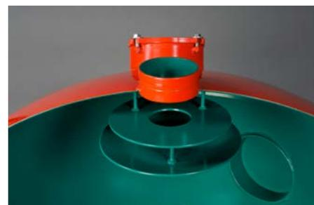
El diámetro de entrada en 5" junto con la placa deflectora de dos pasos reducen la velocidad del flujo de agua que entra en el tanque creando una distribución uniforme a través de la cama de arena.
