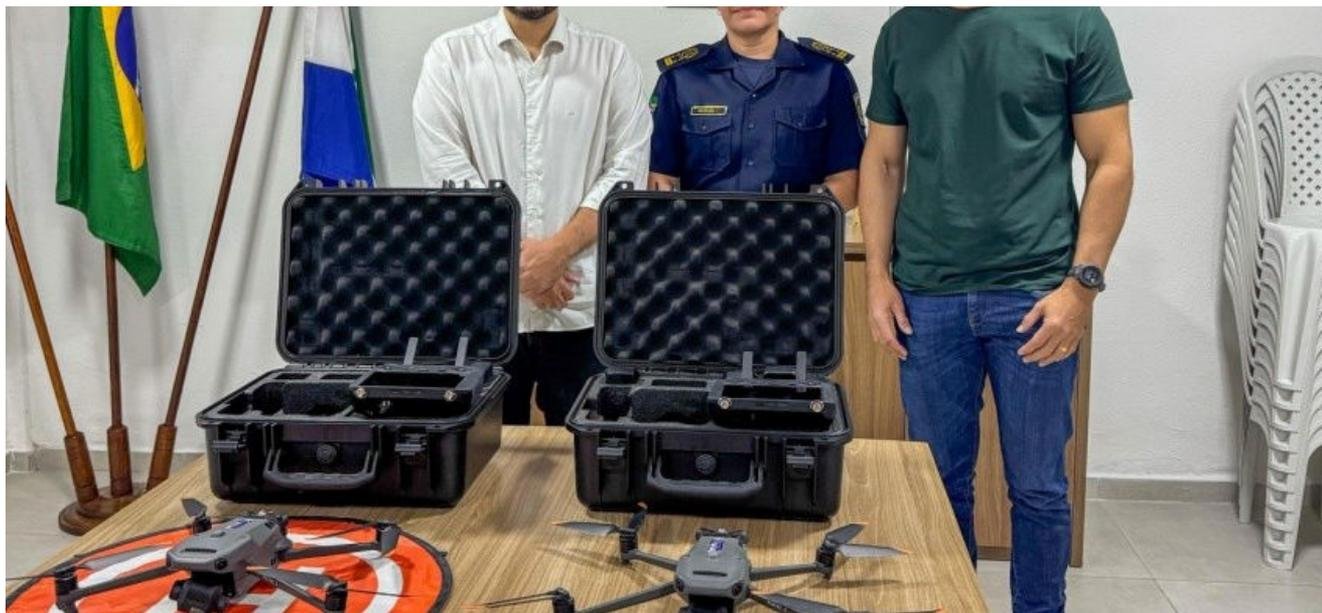
**EQUIPAMENTOS** contam com sensores de calor capazes de identificar pessoas em áreas de baixa visibilidade
