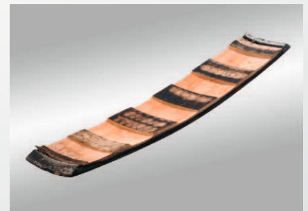
Cask stave with material removal example. Fassdaube mit Abtragsbeispiel.
