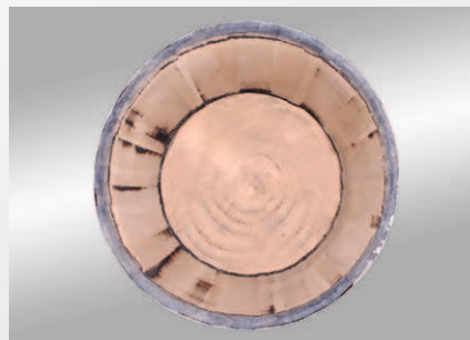
Cask after skiving/grinding. Fass nach dem Raspeln.
