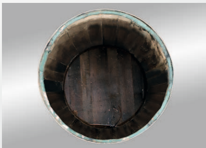
Cask before skiving/grinding. Fass vor dem Raspeln.
