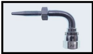
3511-114 | SE&T | HOSE STUD 90° JIC | D JIC 37° 7/16 | H 20,7 | L 25,7 | HOSE Ø 4
