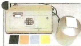
La photo de gauche montre un réflectomètre—une machine qui calcule la réflexion solaire des toitures. Consultez la charte ci-dessous pour les valeurs de réflexion des nouvelles couleurs hi-R de Classic.
