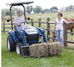
Cuando las cosas se ponen difíciles, simplemente pise el pedal de bloqueo del diferencial y ambas ruedas traseras se bloquean para adicionar tracción y salir de condiciones adversas o resbaladizas.
