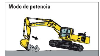
La fuerza de empuje del aguilón se incrementa y mejora la operación de excavación de zanjas y cajones en terreno duro.
