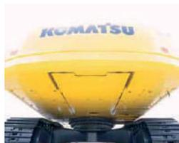
Cubierta inferior reforzada del bastidor giratorio
