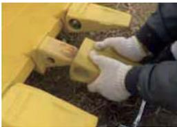
Coloque el diente PAB en el adaptador tipo pasador.
