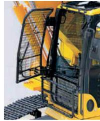
• Protección delantera completa de la cabina nivel 2 (ISO 10262).
