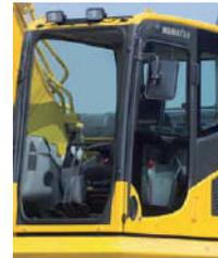
La ventana delantera está fija y se compone de vidrio laminado de seguridad para impedir que el vidrio se disperse en caso de que se quiebre.
