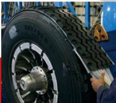
De acuerdo a los criterios definidos entre el transportador y el renovador se procederá a aplicar la banda de rodamiento nueva sobre la carcasa en proceso.
