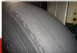
Luego de hacer los rellenos correspondientes a las diferentes acciones de cardeo y reparación se hace el encementado (caucho especial en estado liquido con solvente) para aplicar el cojín.
