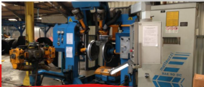
Para darle una nueva vida a su neumático es necesario retirar los remanentes de caucho de la banda de rodamiento anterior.
