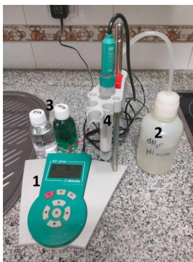
Figura A1.3.1: pH-metro, disoluciones y frasco lavador utilizados para medir el pH de las piezas de carne.
