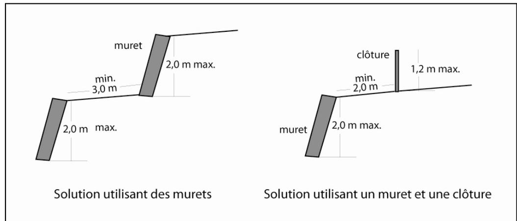
Lorsqu'un muret et une clôture en surplomb sont requis, une clôture doit être distante d'au moins deux mètres (2 m) du muret.
