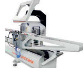
UZUN PROFİLLERDE OTOMATİK DESTEK AYAĞI AUTOMATIC SUPPORT FEET FOR LONG PROFILES
