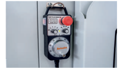
Kolay profil tanımlama (el çarkı) Easy profile identification (handwheel)
