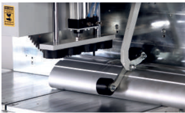
Parçaya uyumlu pistonlar Pistons compatible to the part
