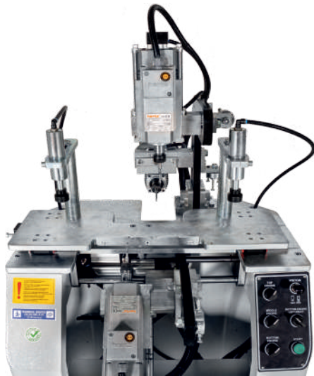
SAĞA VE SOLA HAREKETLİ TABLO RIGHT AND LEFT MOVING TABLE
